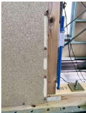
次に下写真2枚は無機質系耐力面材の最終破壊状態です。
