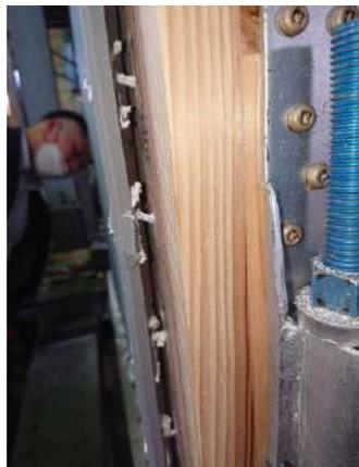
右写真は同面材に制震テープを付加した実験結果です。制震テープが面材の先行破壊を補強している事が分かります。
